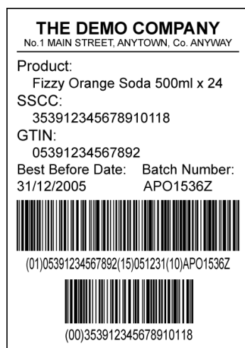
Рис. 2. Пример этикетки с кодом EAN-128 (GS1–128)
