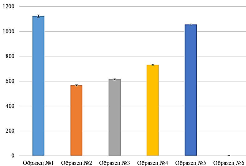
Рис. 3. Прочность гелей экспериментальных эмульсий при деформации, г/см<sup>3</sup>
